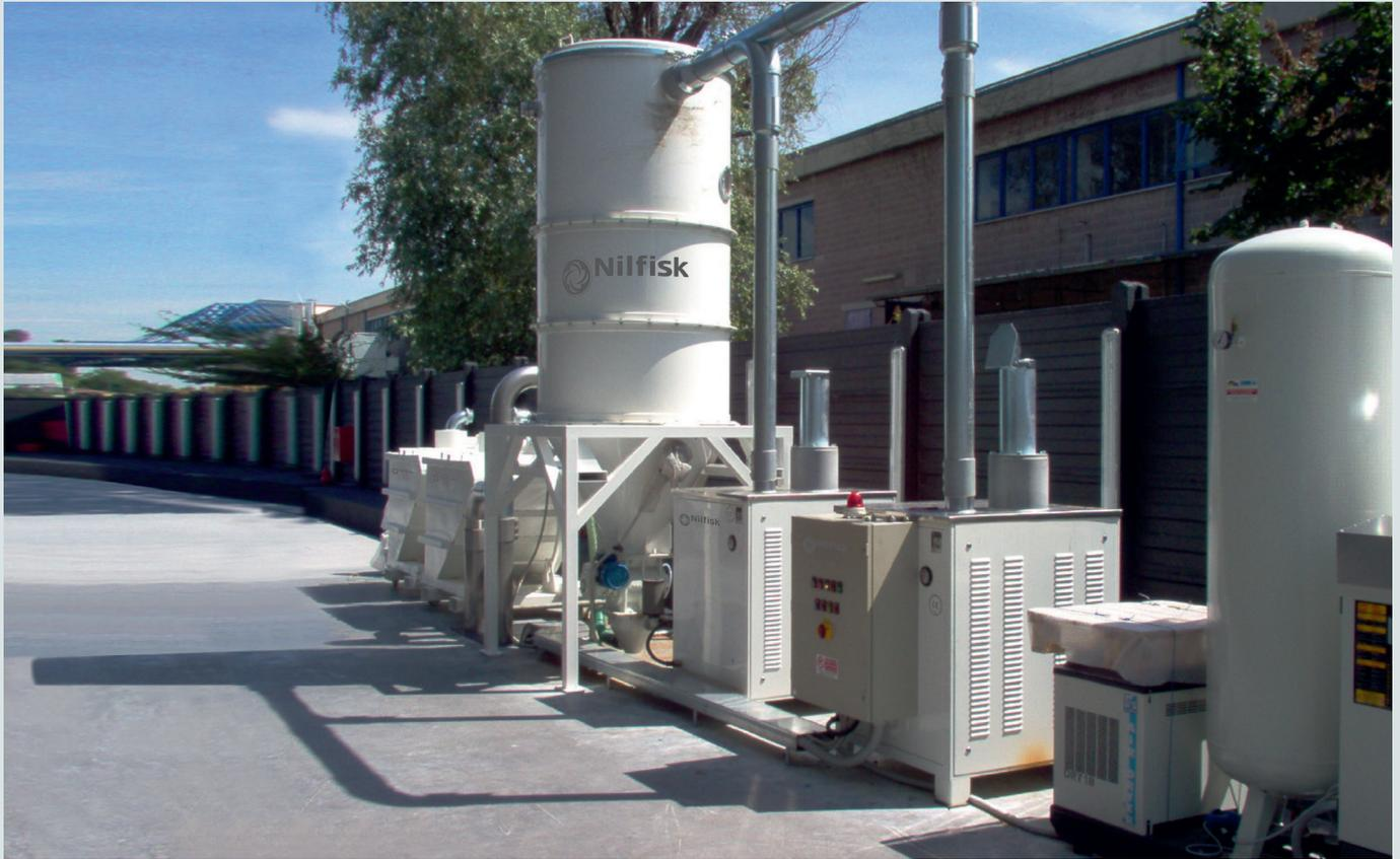
**Os transportadores pneumáticos** são um método eficiente para mover pó e granulado. Automatizam a produção, transportando o pó ou granulado de contentores até às máquinas de produção. Os colaboradores alimentam os misturadores, reatores, máquinas de granulado, máquinas de cápsulas, compressores e máquinas de ensacar. Os transportadores pneumáticos aceleram o processo de produção, mantendo o ambiente saudável e seguro.
