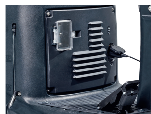
Um carregador a bordo integrado permite uma carga fácil da bateria em qualquer local.
