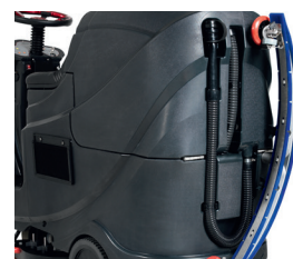
Suporte na parte traseira para colocar o bocal e desta forma passar em locais estreitos.
